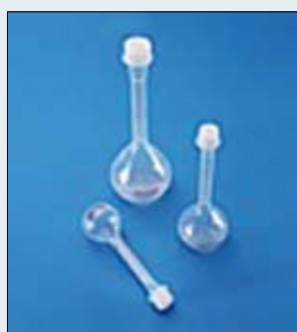
Nr kat. 2.02.07 Kolba miarowa z tworzywa *PMP (TPX)-kl.B - z nakrętką PP, przeźroczysta
