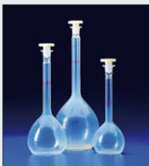
Nr kat. 2.02.05 Kolba miarowa z tworzywa *PMP (TPX)-kl.A - z korkiem przeźroczysta, indywidualnie cechowana pojemność, korek z tworzywa PP, nadrukowany numer i załączony certyfikat
