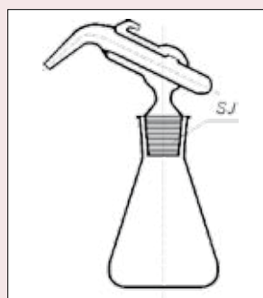
Nr kat. 7365 Pipeta automatyczna Kippa z kolbą, na szlif SJ 29/32
